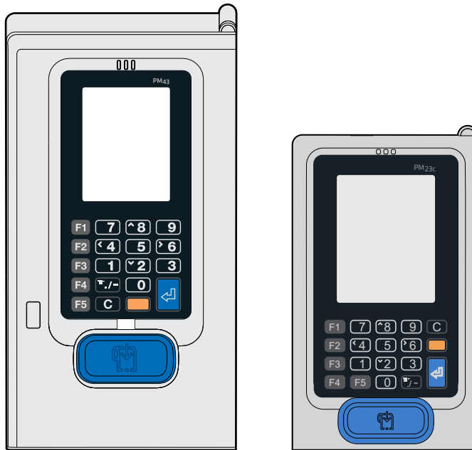
Il pannello anteriore con display tattile di una stampante PM43
